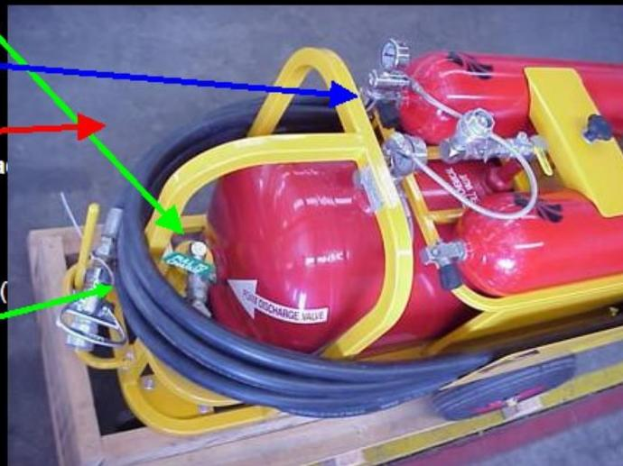
Los equipos CAF están equipados con una válvula de desfogue que no permite que el tanque principal se sobrecargue
